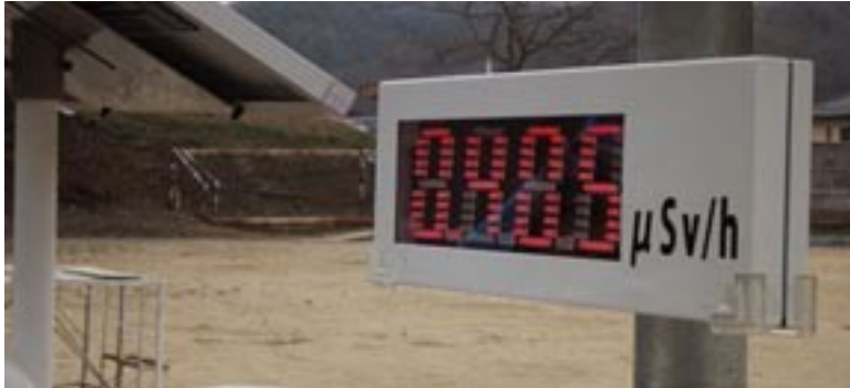
各地に設置されている モニタリングポスト
